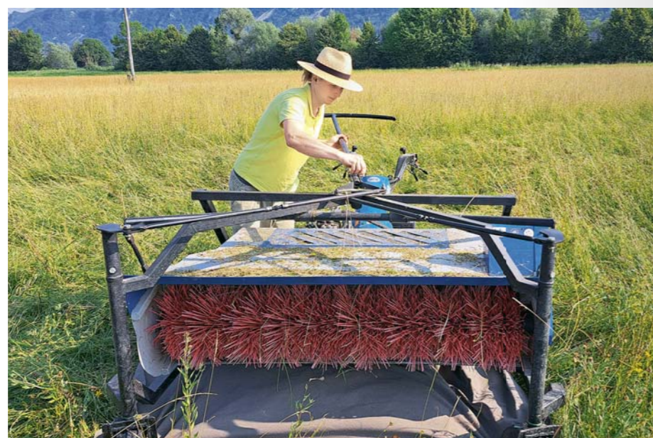
NABIRANJE SEMEN S KRTAČNIM STROJEM
